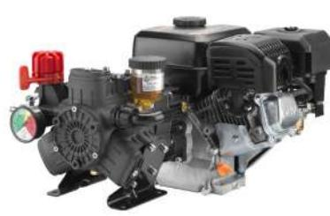
Groupe motopompe AR 303 BlueFlex™, Rato EHR 180, recul intégré, socle moteur seul. Pompe semi-hydraulique à trois membranes, pour une utilisation dans les secteurs du jardinage ou de l'agriculture semi-professionnelle. Parties en contact avec les liquides pompés en aluminium anodisé, et AISI 303/304
